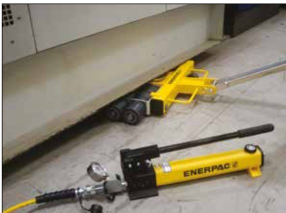
◀ Ein Enerpac Wälzwagen der MLS-Serie kombiniert mit einem hydraulischen Kurzhubzylinder bildet das ideale Gesamtpaket für die Bewegung von Maschinen.
